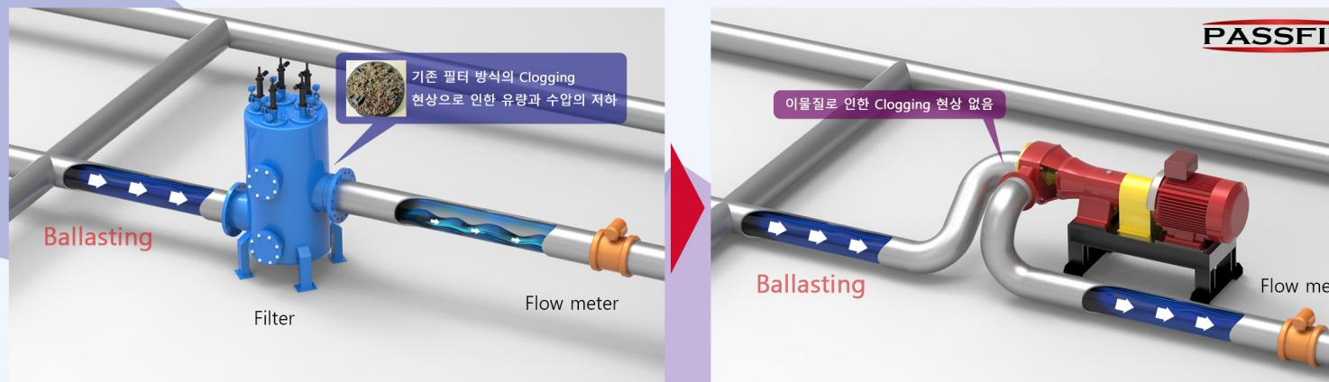
▲ 기존 필터 방식은 여과방식으로서 생물을 포함한 수중의 입자를 물리적으로 거르기 때문에 필터 Element의 Pore가 막히는 Clogging 현상이 발생.
